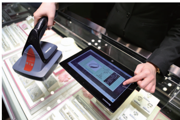
於庫存盤點時，使用手提電子盤點器 掃描線射頻標籤
